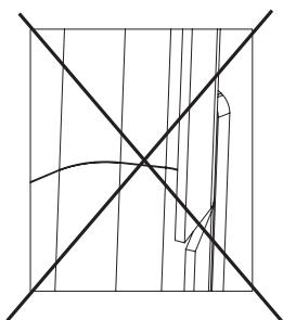
3) зафиксировать направляющую в горизонтальном положении при помощи вспомогательных стоек или за счет подвеса на веревке к элементам конструкции потолка. Горизонтальность положения направляющих проверять с помощью брускового строительного уровня.
