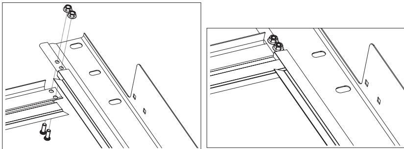
Рис. 7.3. Установка нащельника
