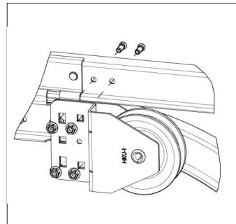
Рис. 16. Крепление блока НКУ-1 к горизонтальной направляющей.
