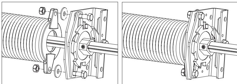
Рис. 24. 1. Крепление пружины к храповой муфте
