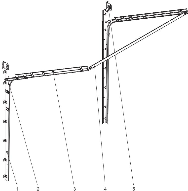
1 – Опорная стойка с вертикальной направляющей и уплотнительной вставкой
