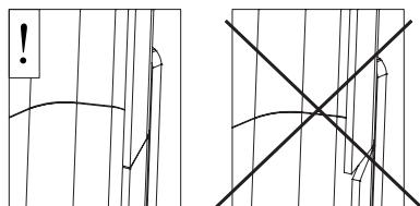
Демонтировать мерную планку, для чего отвернуть гайки нижних пресс-болтов и извлечь их (рис. 14).
