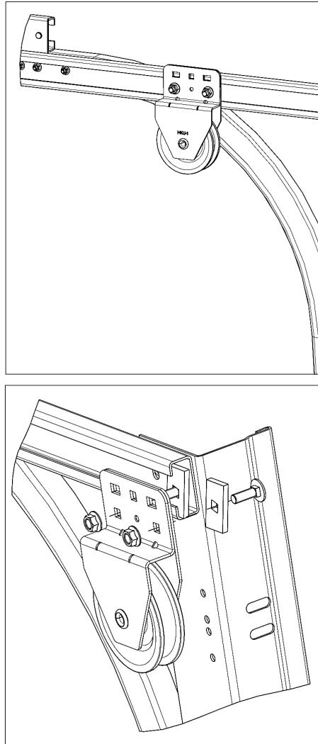
Рис. 38.1. Крепление блока НКУ-1 к горизонтальной направляющей
