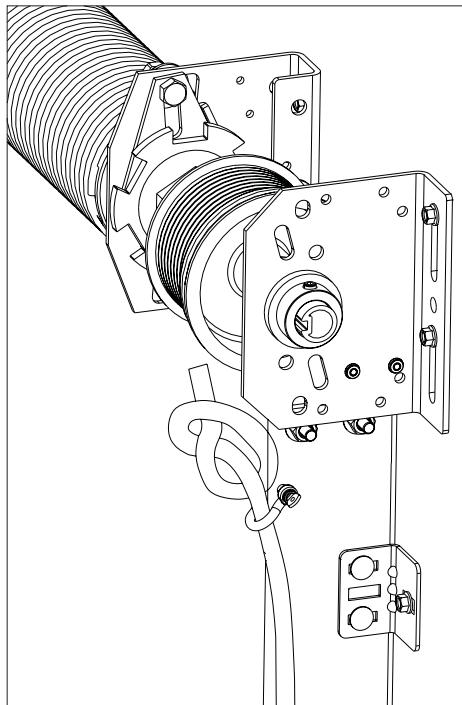
Рис. 34.1. Крепление каната к стойке
