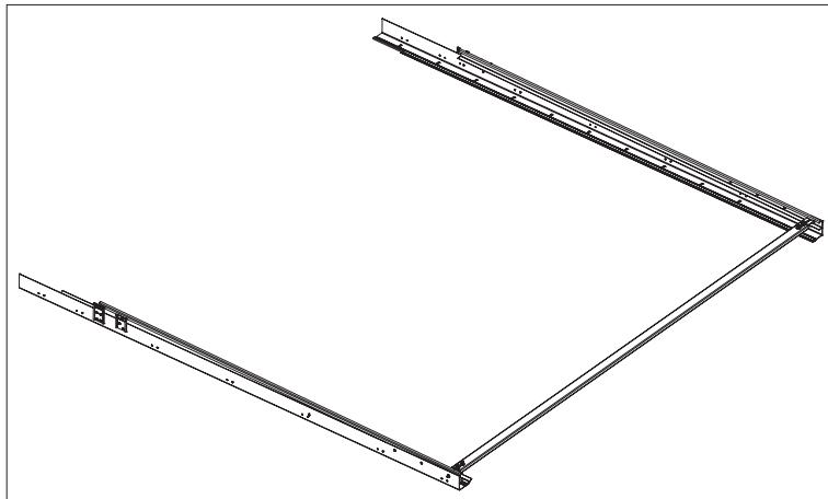
Рис. 9. Вертикальная рамка несущего каркаса в сборе
