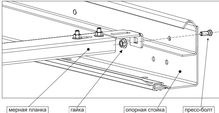
Рис. 9.2. Крепление мерной планки к опорной стойке
